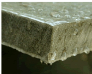
Immagini di pannelli Ecomat, costituiti da sansa esausta, polipropilene e fibra di vetro
