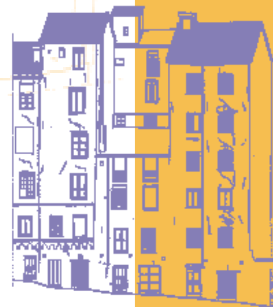
Nelle foto: Piazza dei Truogoli di Santa Brigida, Vico Tacconi e Piazza S. Elena nelle fasi della campagna di rilevamento topografico e fotogrammetrico. Nei disegni: restituzione fotogrammetrica del prospetto su Piazza S. Elena e degli edifici di Vico Tacconi e di Piazza dei Truogoli di S. Brigida.
